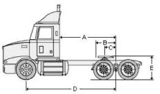
A=BACK OF CAB TO TRUNION B=FIFTH WHEEL SLIDE LENGTH C=FIFTH WHEEL OFFSET D=WHEELBASE E=FIFTH WHEEL HEIGHT
